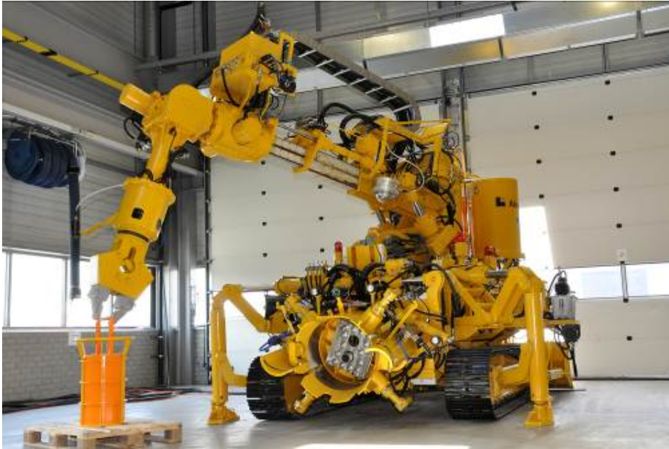
配备博世力士乐改进型液压装置的 Aker Wirth 海底履带牵引车
