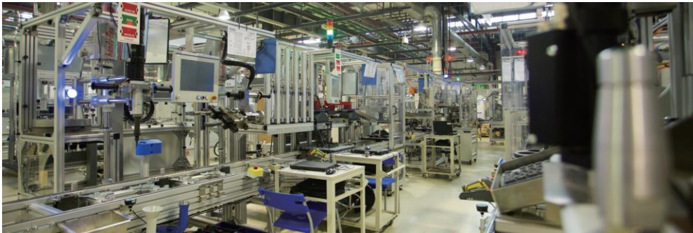
秦川集团机器人关节减速器装配线
